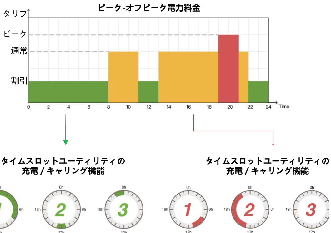
3つの定義可能な期間で、ユーザーは00:00から23:59の範囲で商用電源からの充電/運搬時間を自由に設定できます。ユーザーが設定した時間で、PVエネルギーが利用可能な場合、PVエネルギーが最初に使用され、PVエネルギーが利用できない場合や不十分な場合は、商用電源エネルギーが補足として使用されます。
